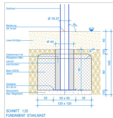
Schnitt 1:20 Fundament Stahlmast
