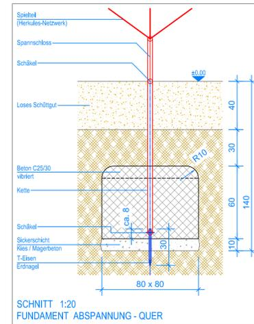
Schnitt 1:20 Fundament Abspannung - QUER
