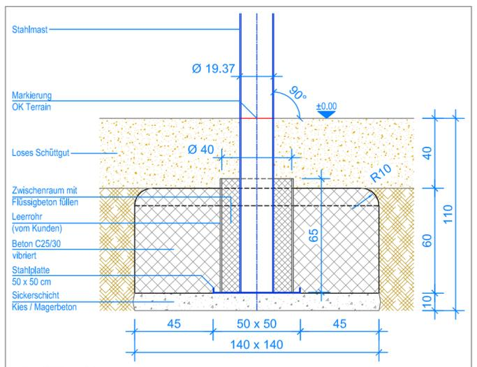
SCHNITT 1:20 FUNDAMENT STAHLMAST
