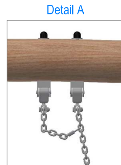
Sicherungskette: Rapid-Schnellverschluss am vierten Kettenglied von oben befestigen
