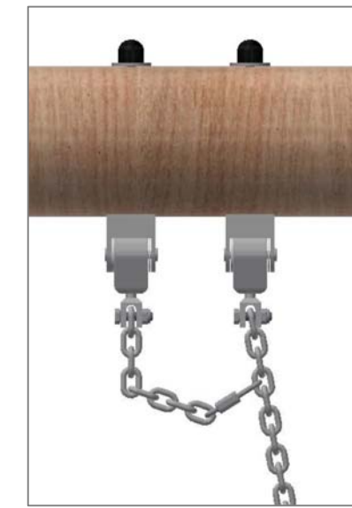
Chaîne de sécurité: Mousqueton à fixer dans le 4ème maillon
