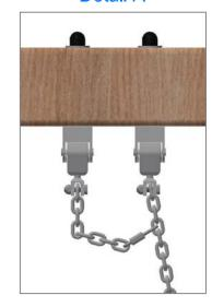
Sicherungskette: Rapid-Schnellverschluss am vierten Kettenglied von oben befestigen
