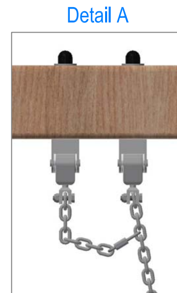
Sicherungskette: Rapid-Schnellverschluss am vierten Kettenglied von oben befestigen
