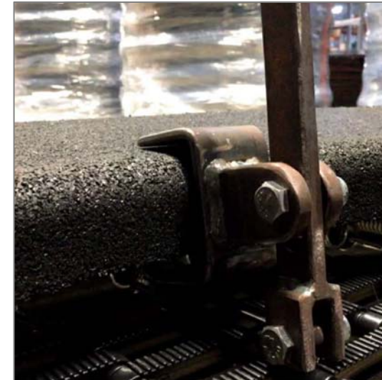
Bild-2 : Lösen der Federn, angesetztes Hakenwerkzeug
