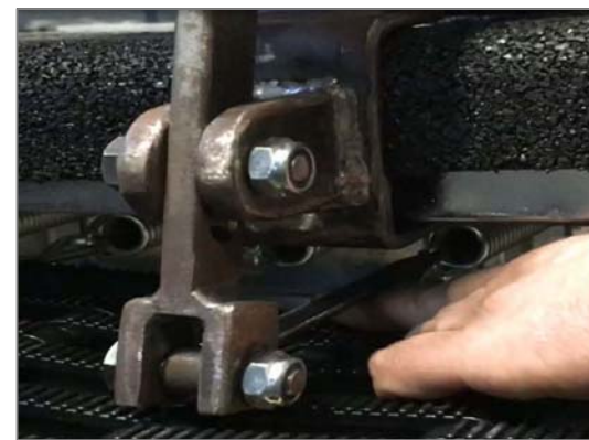
Bild-4 : Gespannte Feder
