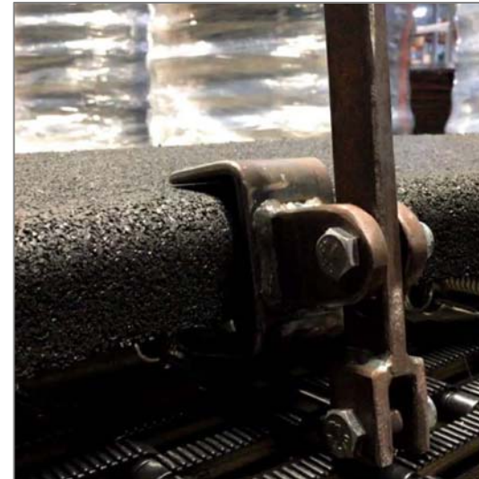
Bild-3 : Lösen der Federn, angesetztes Hakenwerkzeug
