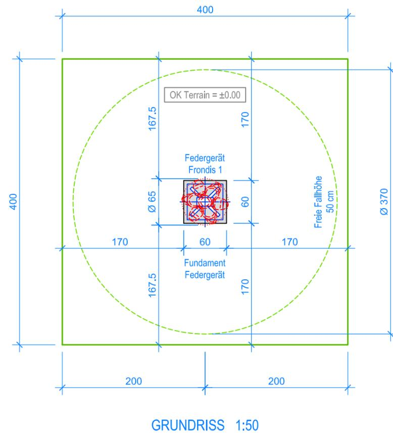
— Aussenkante Fallschutzplatten
